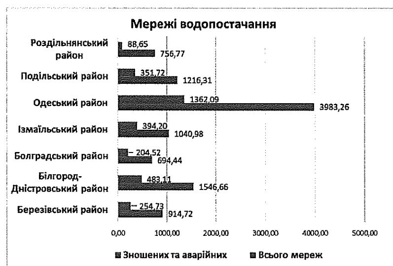
Загальна протяжність водопровідних мереж області становить 10153,132 км, з яких 30,9 % перебуває у руйнівному та аварійному стані, протяжність каналізаційних мереж області становить 1863,896 км, з яких зношених 42,55 % від їх загальної довжини.
